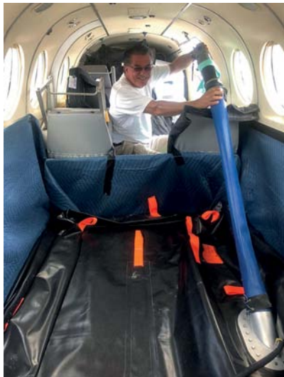
Mit dem Blasen-Zusatztank lässt sich die Reichweite deutlich erhöhen
